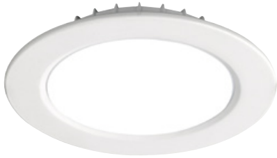
■ 다운라이트 6인치 Size_ Ø174×H65 (타공 : Ø150) Lamp_ LED 12W/15W/20W
